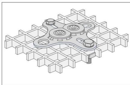
Отклонитель «Колодец» применяется в технике веревочного доступа (промышленном альпинизме) и предназначен для защиты веревки (каната) от опасности перерезания или повреждения острыми кромками напольных решеток. Для этого веревка должна проходить сквозь втулку отклонителя, установленного и закрепленного на напольной решетке.
