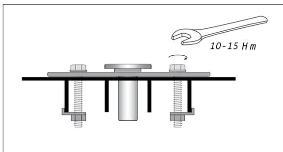
2. **ОБЯЗАТЕЛЬНО** закреплять отклонитель к напольной решетке болтами с обеих сторон, затягивая их гаечным ключом с усилием 10-15 Нм.
