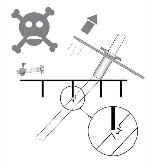
Также существует опасность отлетания отклонителя при выбирании веревки из незакрепленного отклонителя: утолщение на конце веревки, применяемое для маркировки, может зацепиться и в случае резкого рывка работником, который выбирает веревку, – отклонитель может резко вылететь и полететь в самых разных направлениях, включая в самого работника или за край площадки.
