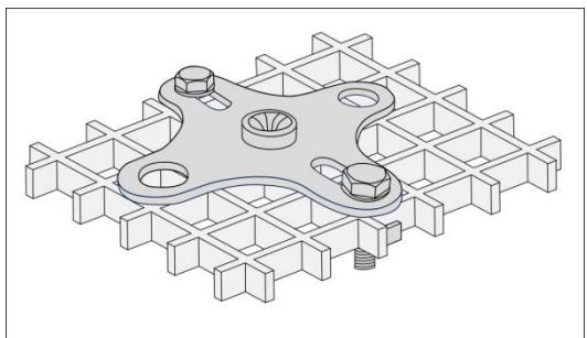
Отклонитель «Колодец» применяется в технике веревочного доступа (промышленном альпинизме) и предназначен для защиты веревки (каната) от опасности перерезания или повреждения острыми кромками напольных решеток. Для этого веревка должна проходить сквозь втулку отклонителя, установленного и закрепленного на напольной решетке. Отклонитель может использоваться только с текстильными веревками (канатами).
