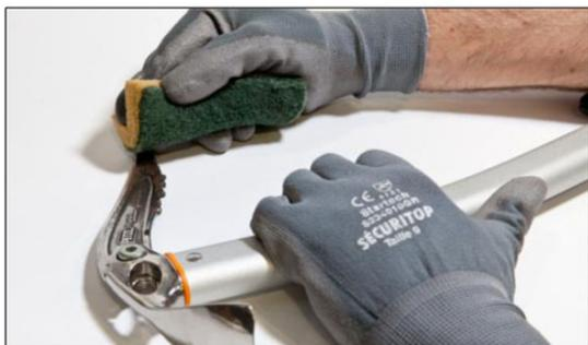
Протирайте клювы ледорубов сухой тряпкой после каждого использования для предотвращения возникновения коррозии. Для лучшей защиты смажьте клювы масляной или силиконовой смазкой.
