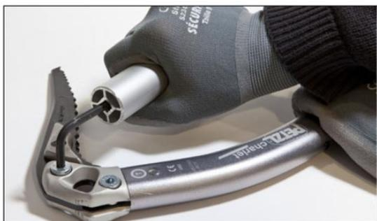
Используйте ручной напильник для предотвращения перегрева. Перегрев снижает прочность стали. Для заточки ледовых инструментов и кошек не используйте электрические точильные станки. Используйте плоский напильник по металлу. Охлаждайте клювы в воде в случае необходимости. Перегретые во время заточки клювы и кошки теряют прочность и будут быстро тупиться во время использования.
