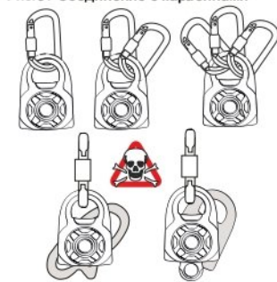
Рис. 5. Соединение с карабинами
