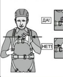
Рис. 13. Позиционирование в рабочем положении
