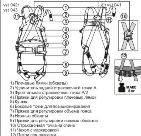
Рис. 2. Типы крепежных точек
