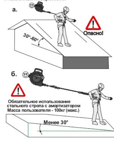
Рис. 9. Использование на горизонтальных и наклонных поверхностях
