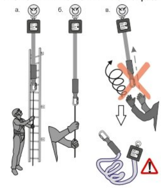
Рис. 10. Вытягивание и втягивание троса
