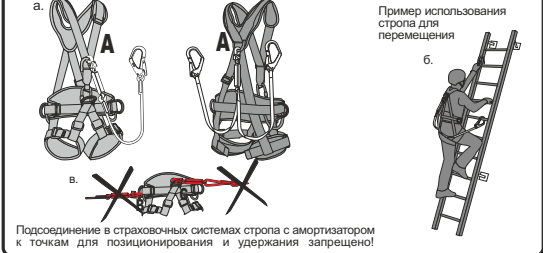
Рис. 6. Использование карабинов, входящих в состав стропов
