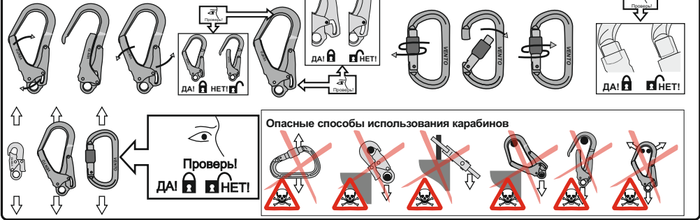
Рис. 7. Способы крепления стропов к анкерным устройствам
