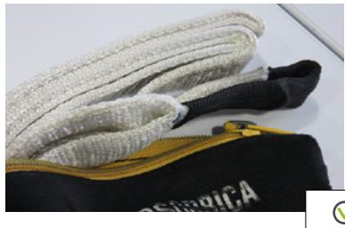
• Амортизатор рывка подвергся рывку, начался разрыв амортизатора
