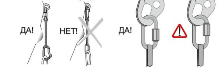
Рис. 6. Использование оттяжек с рапидами «Link 8»
