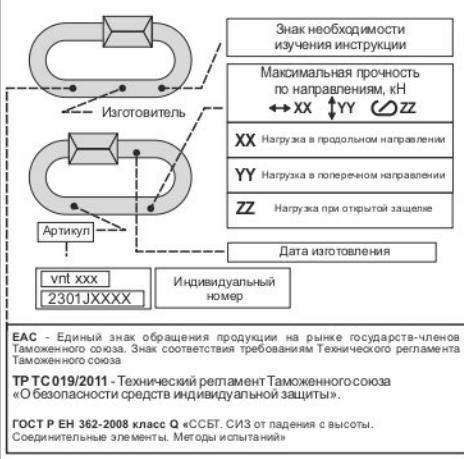
**Рис. 3. Приложение нагрузки к карабину**
