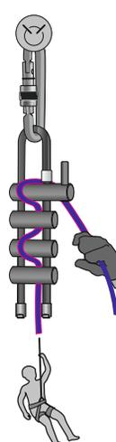
Рис. 7. Фиксация веревки
