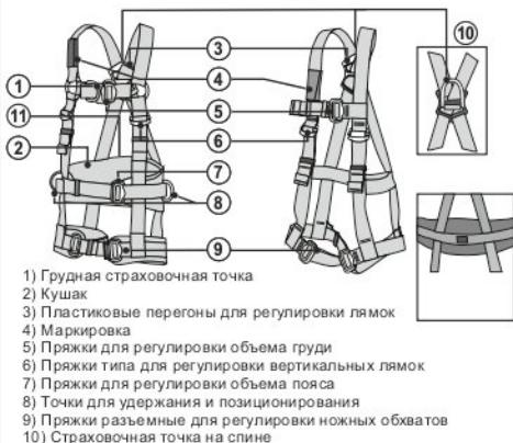
**Рис. 2. Типы крепежных точек**
