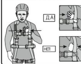
**Рис. 5. Способы надевания привязи**
