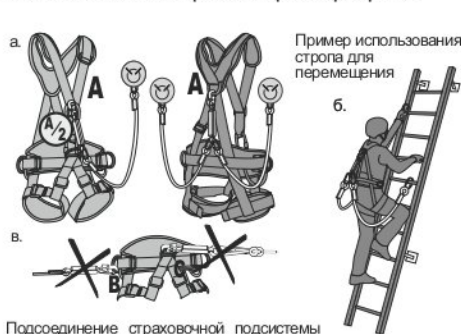
Рис. 8. Использование стропы с амортизатором рывка
