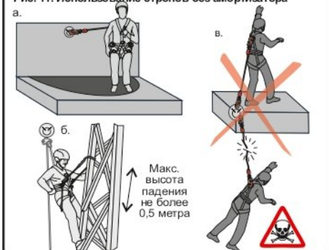
Рис. 11. Использование стропов без амортизатора
