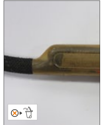
• Поврежденный пластиковый протектор
