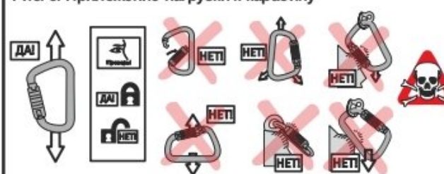
Рис. 3. Приложение нагрузки к карабину
