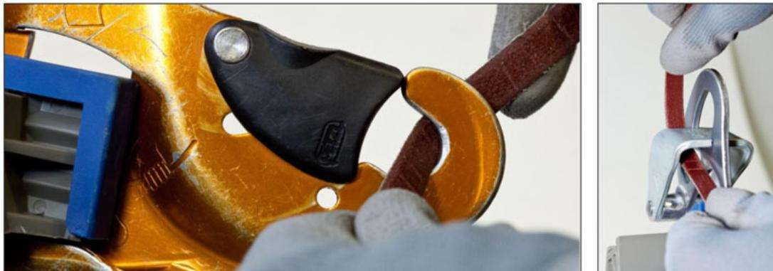
Вы можете вручную зачистить острые края с помощью мелкой шкурки, чтобы продлить срок службы спусковых и страховочных устройств. Не забывайте про ограничение износа в 1мм. Если в процессе зачистки общая глубина износа достигла 1мм, снаряжение необходимо списать.
