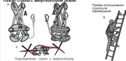
Рис. 5. В страховочных системах допускается использование только стропов с амортизатором рывка
