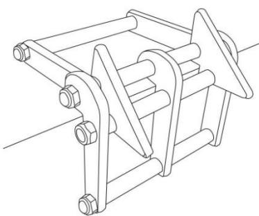
Отклонитель «Карлс» является одной из разновидностей устройств защиты опорных линий (веревок) от повреждений на острых или абразивных кромках с перегибом через них около  $90^0$ . Используется в промышленном альпинизме (системах канатного доступа). Удобно проходится при вывешивании промышленного альпиниста с крыши (площадки) на веревки.
