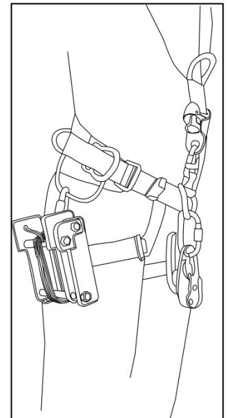
**С осторожностью** следует использовать отклонитель в ситуациях, когда веревка входит в него сверху не горизонтально, а наискось сверху, не прижимая задний опорный валик отклонителя к поверхности крыши или площадки.
