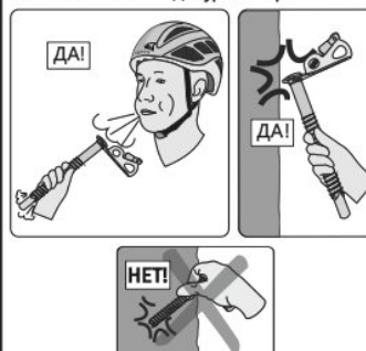
Рис. 10. Очистка ледобура от керна
