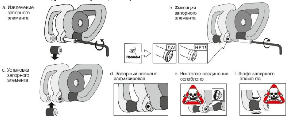
Рис. 4. Извлечение, установка и фиксация запорного элемента
