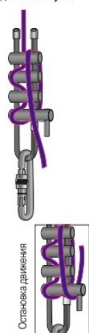
Рис. 5. Заправка веревки для медленного спуска
