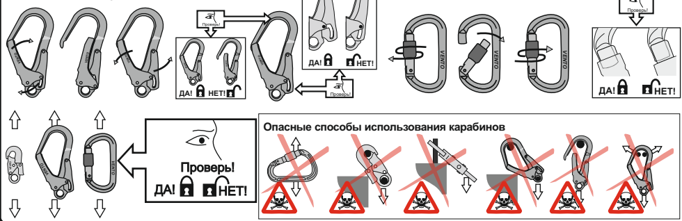
Рис. 7. Способы крепления стропов к анкерным устройствам
