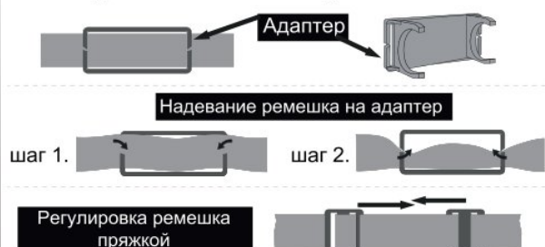
Рис. 2. НАДЕВАНИЕ РЕМЕШКА НА АДАПТЕР И РЕГУЛИРОВКА
