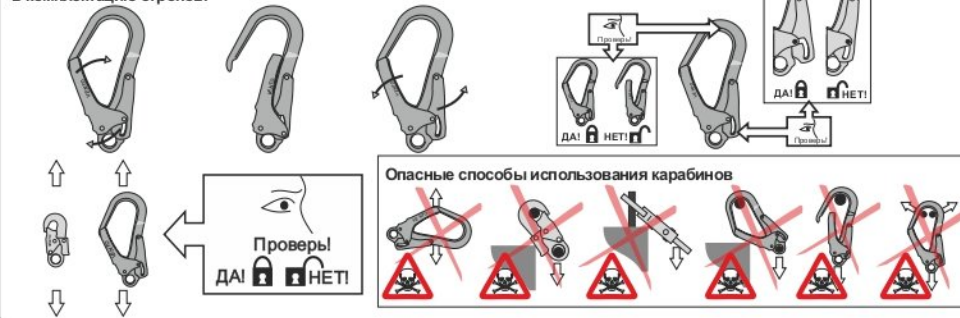
Рис. 6. Способы крепления стропов к анкерным устройствам
