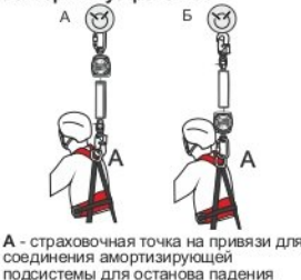
Рис. 5. Общие принципы использования карабинов
