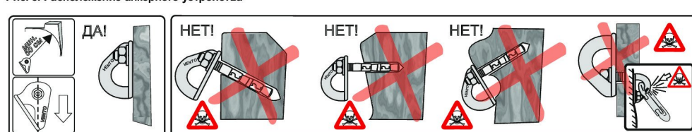
Рис. 5. Расположение анкерного устройства
