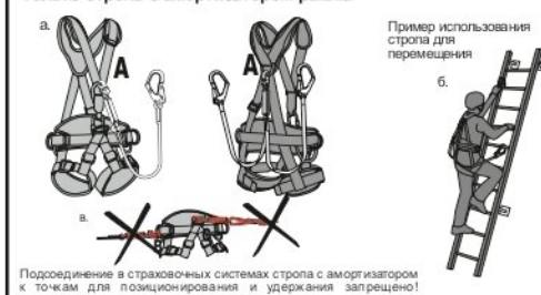
Рис. 4. В страховочных системах допускается использование только стропа с амортизатором рывка
