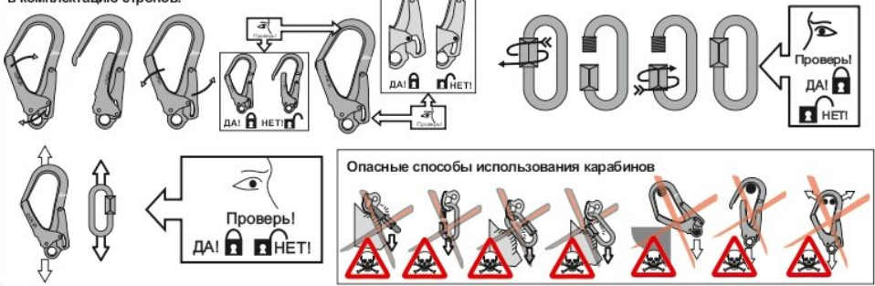
Рис. 7. Способы крепления стропов к анкерным устройствам
