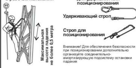
Рис. 17. Пример организации системы канатного доступа
