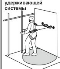
Рис. 15. Способ организации удерживающей системы
