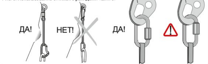
Рис. 6. Использование оттяжек с рапидами «Link 8»
