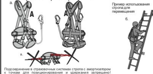
Рис. 6. Использование карабинов, входящих в состав стропов
