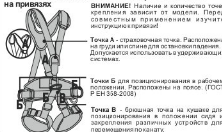
Рис. 5. Способы крепления к анкерным устройствам
