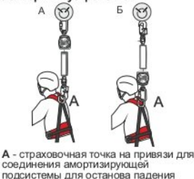
Рис. 5. Общие принципы использования карабинов
