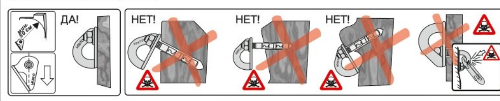
Рис. 4. Расположение шлямбурного уха
