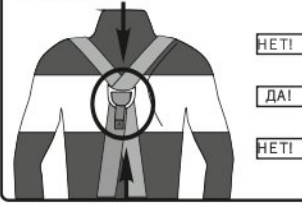
Рис. 6. Правильное положение страховочной точки В на спине
