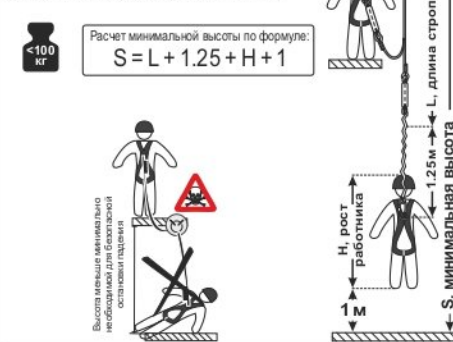
Рис. 9. Способы крепления к анкерным устройствам
