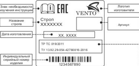
Рис. 2. Идентификация и маркировка изделия
