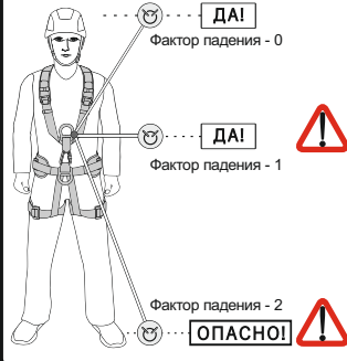
Рис. 9. Соединительно-амортизирующая подсистема
