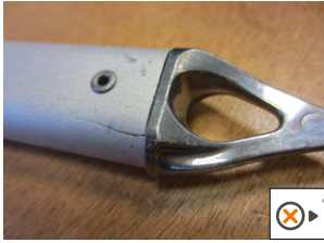
• Трещина на древке
