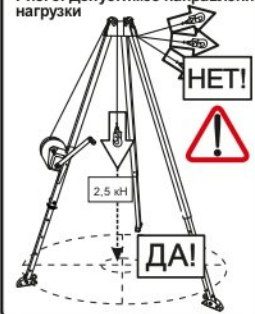
Рис. 8. Допустимое направление нагрузки
