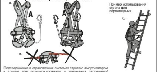
Рис. 6. Использование карабинов, входящих в состав стропов
