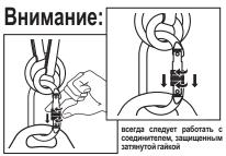
Точка постоянной конструкции, к которой подсоединен ленточный зацеп, должна находиться над местом работы, а ее форма и конструкция должны препятствовать автоматическому отсоединению каната. Минимальная статическая прочность анкерной точки составляет 12 кН.
