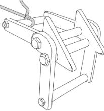
Отклонитель «alpsvet-Малыш» является одной из разновидностей устройств защиты опорных линий (веревок) от повреждений на острых или абразивных кромках с перегибом через них около  $90^{\circ}$ . Используется в промышленном альпинизме (системах канатного доступа). Удобно проходится при вывешивании промышленного альпиниста с крыши (площадки) на веревки.
