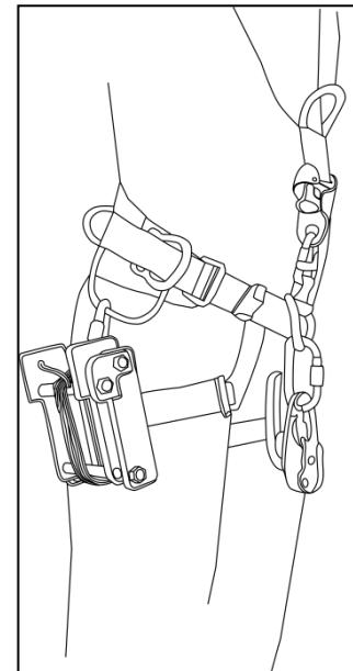
**С осторожностью** следует использовать отклонитель в ситуациях, когда веревка входит в него сверху не горизонтально, а наискось сверху, не прижимая задний опорный валик отклонителя к поверхности крыши или площадки.
