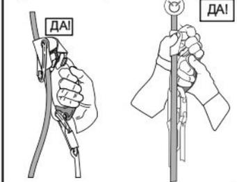
**Рис. 7. Правильное положение жумара при движении по наклонным перилам**
