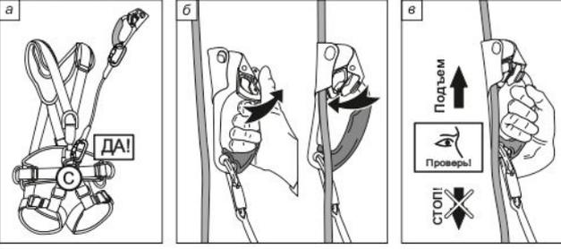
**Рис. 6. Положение жумара на вертикальных перилах**
