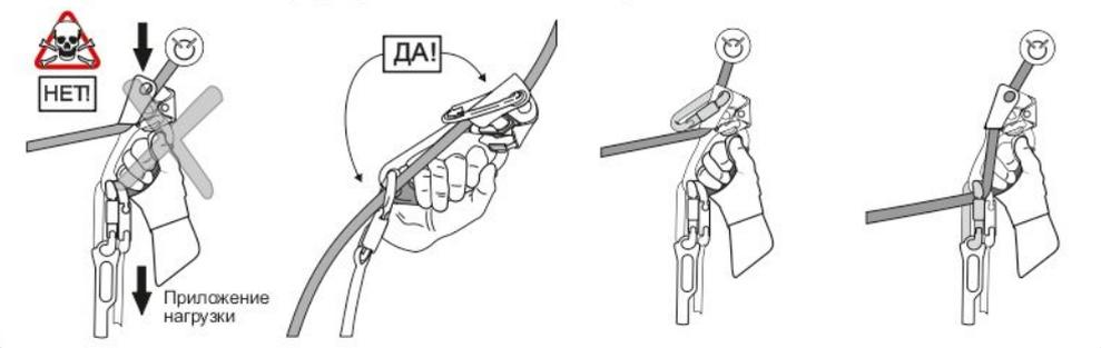
**Рис. 8. Подъем с использованием зажима со стремнем**
