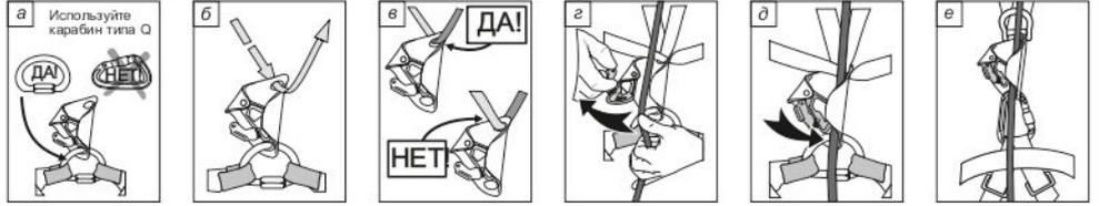
**Рис. 5. Установка жумара на канат**
