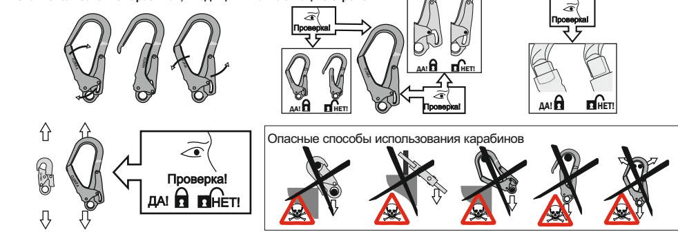
Рис. 7. Способы крепления стропов к анкерным устройствам
