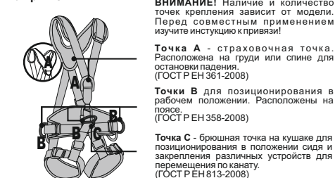
Рис. 4. Расположение и назначение крепежных точек на привязях
